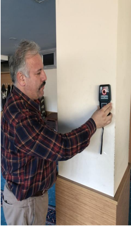
KOLONLARDA DONATI TARAMA CİHAZI İLE ÇALIŞMALARDAN GÖRÜNÜMLER
