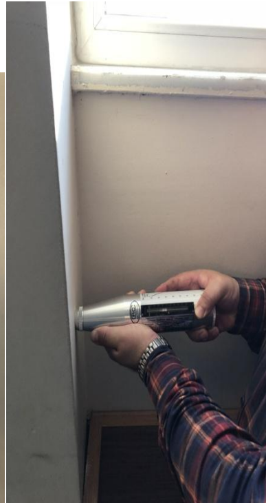
KOLONLARDA SCMİDİTH ÇEKİCİ ÇALIŞMALARDAN GÖRÜNTÜLER
