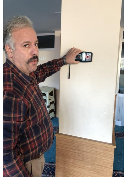
KOLONLARDA DONATI TARAMA CİHAZI İLE ÇALIŞMALARDAN GÖRÜNÜMLER
