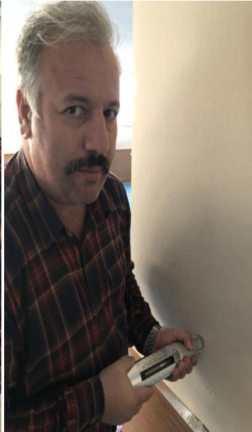
KOLONLARDA SCMİDİTH ÇEKİCİ ÇALIŞMALARDAN GÖRÜNTÜLER
