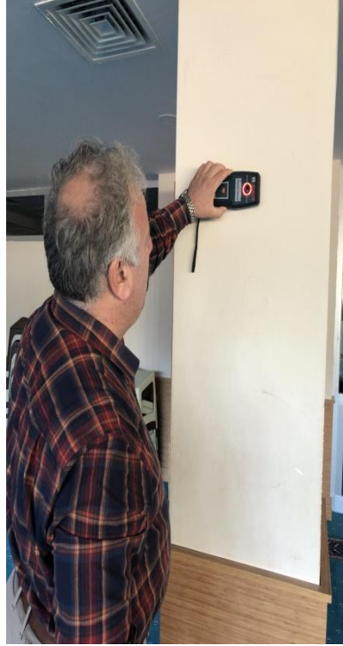
KOLONLARDA DONATI TARAMA CİHAZI İLE ÇALIŞMALARDAN GÖRÜNÜMLER
