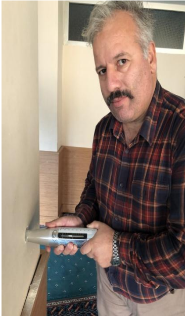
KOLONLARDA SCMİDİTH ÇEKİCİ ÇALIŞMALARDAN GÖRÜNTÜLER
